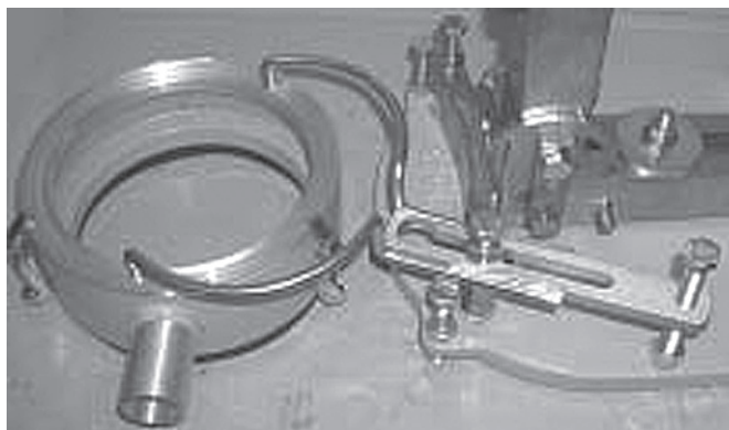
Водосборное кольцо с держателем на подножке P-3000-Uni смонтированы на вакуумной плите VP-150 Рис. 3.57
