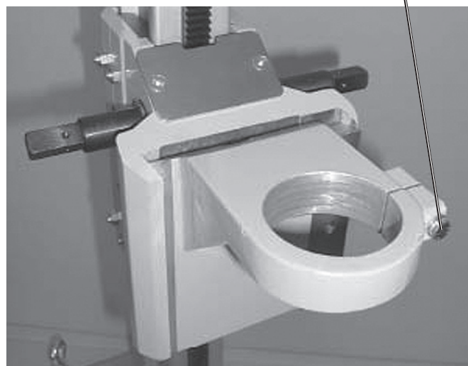
Пластина для моторов с шейкой крепления (тип В, 4831) смонтирована на салазки H-201 (позиция 1, аналог P-3000)
