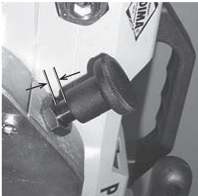
P-3000-Фиксатор салазок снят (позиция перемещение) Рис. 3.72
