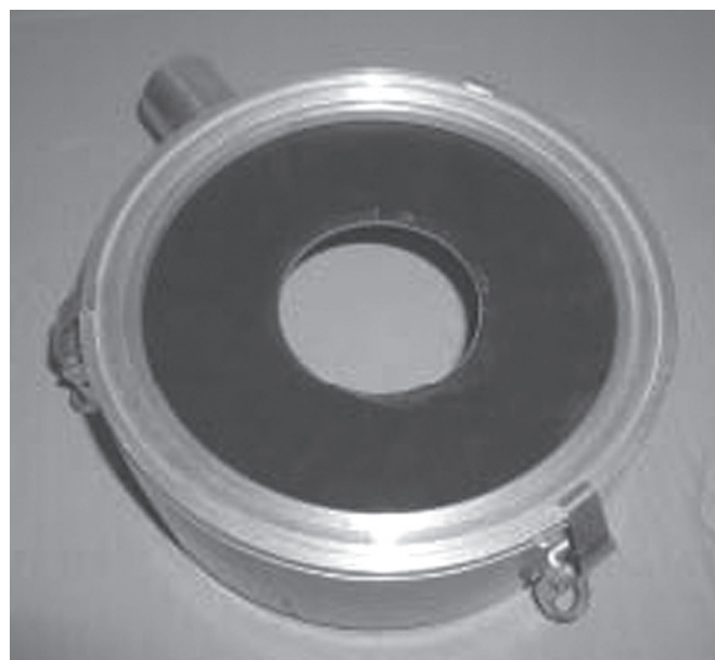
Водосборное кольцо с надетым уплотнит. кольцом (для коронок Ø 81 мм) и прижатой крышкой Рис. 3.53
